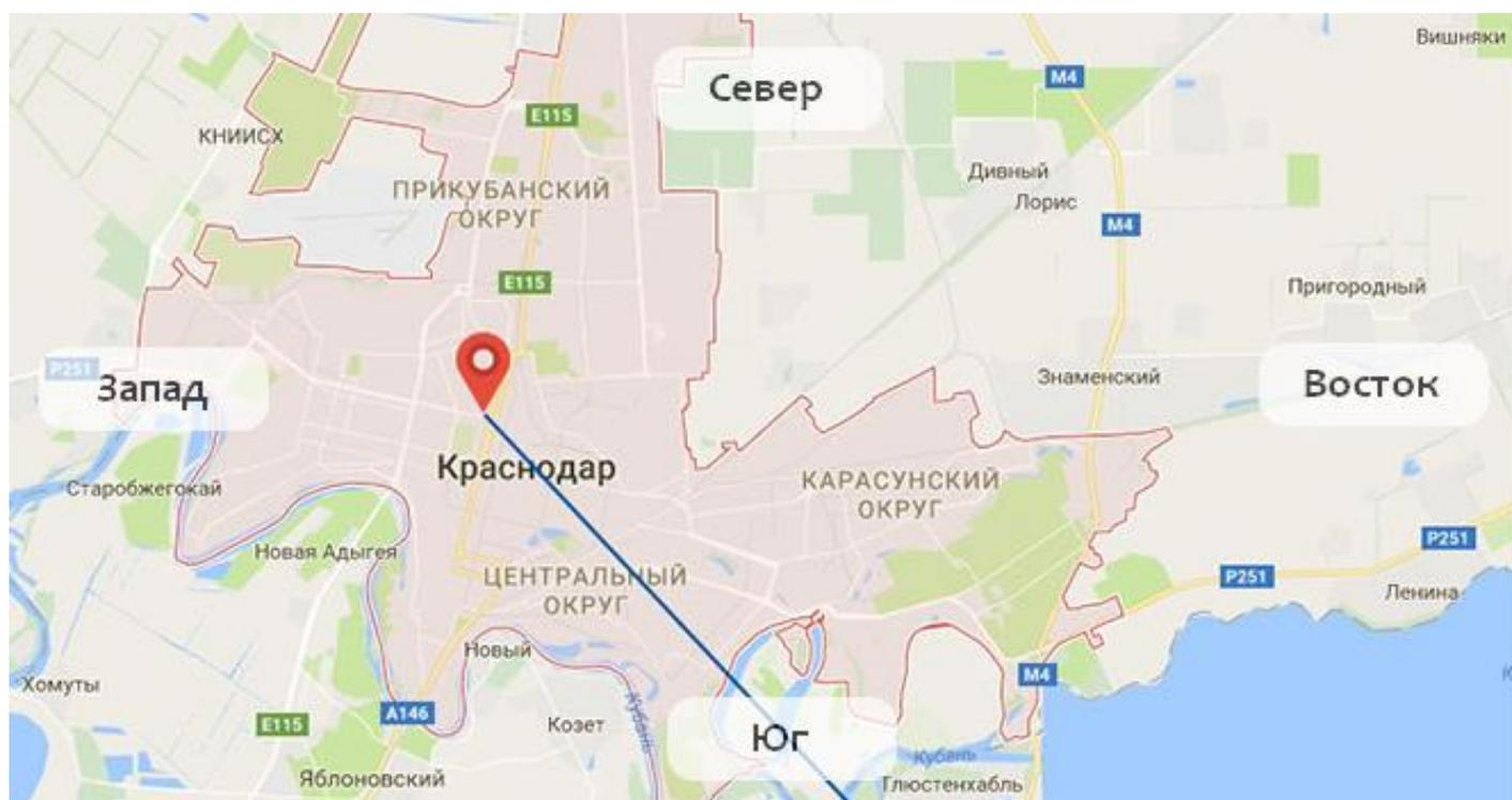
2. Закрепите антенну на стене дома так, чтобы она находилась на линии направления к спутнику. Чтобы прием был сильным, в этом направлении должен быть чистый горизонт без препятствий в виде высоких домов или деревьев
